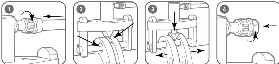
Подсоедините РВД к прессу через БРС. Плотно затяните гильзу БРС, приложив достаточное усилие (от руки) для обеспечения хорошего соединения (без применения слесарного инструмента).
